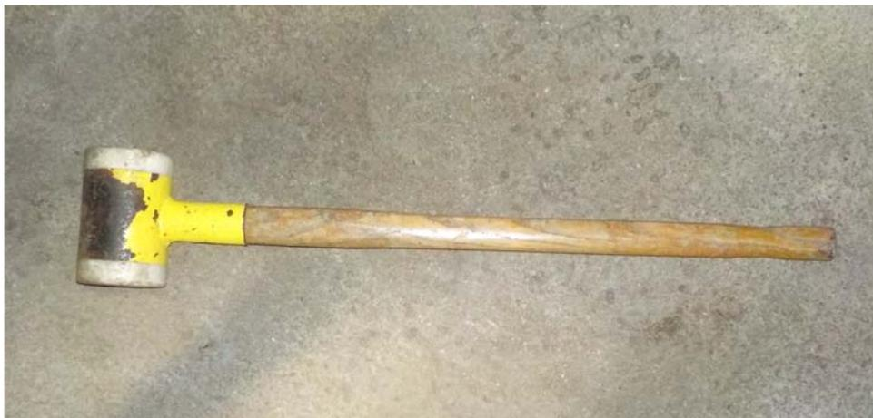
La masse actuelle, plastique dur et poids intérieur, à remplacé avantageusement l'ancienne masse de fer.
