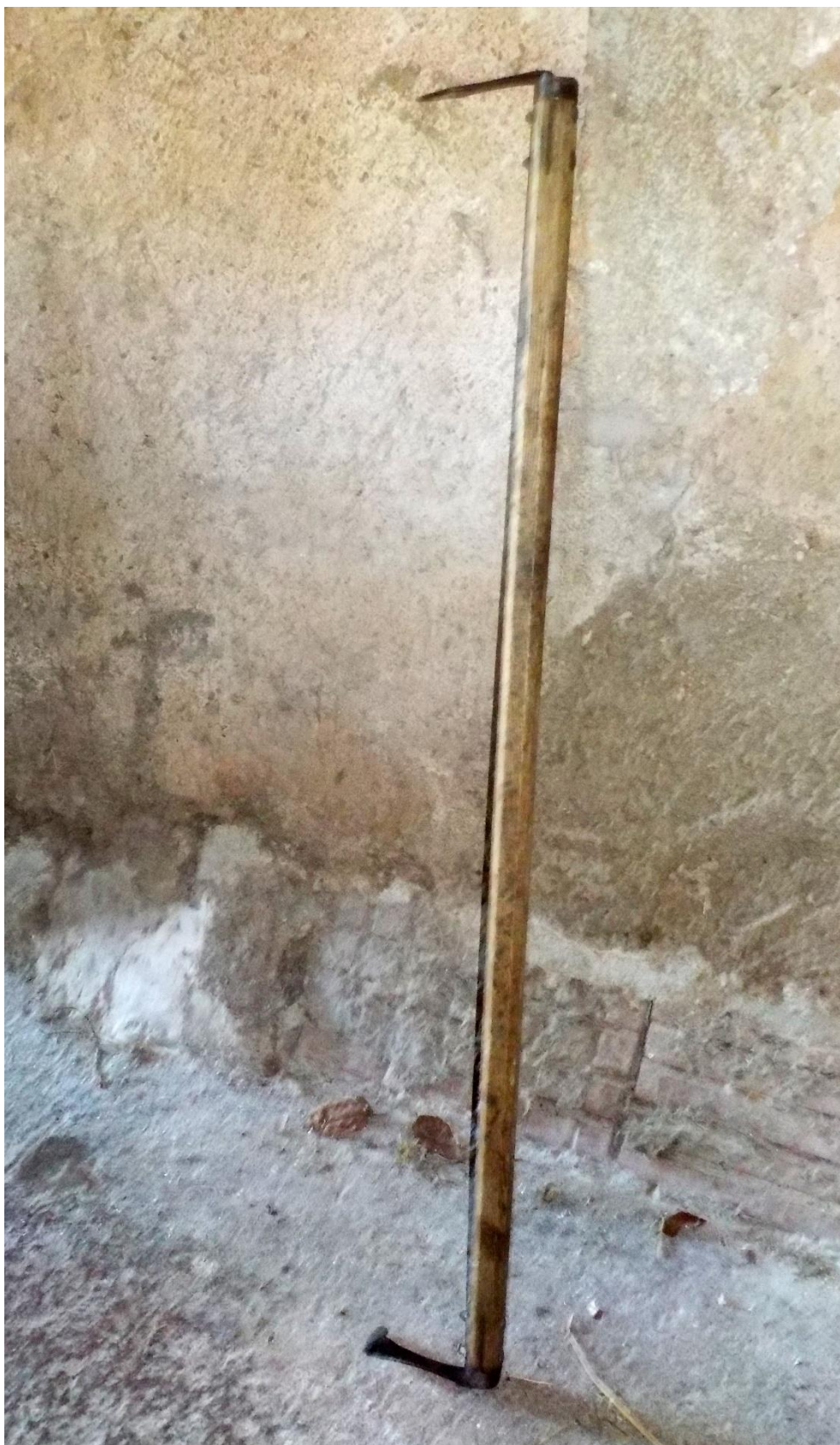
Mesure d'un mètre sans échelle. Une pointe à un bout, une griffe à l'autre.
