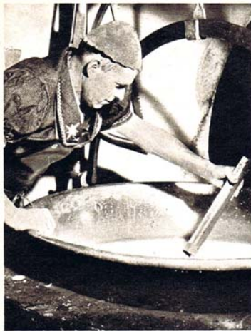
4 Il est indispensable que la température du chaudron soit maintenue à 25 degrés, si l'on veut une qualité parfaite.
