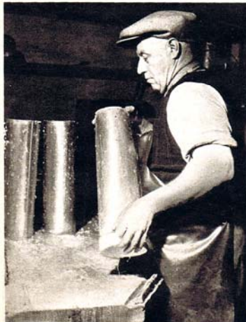
10 Après cinq heures de repos, on procède à l'opération délicate du démoulage.
