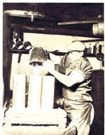
9 Pour accélérer le travail, le contenu de chaque petit moule est versé dans un moule plus haut.
