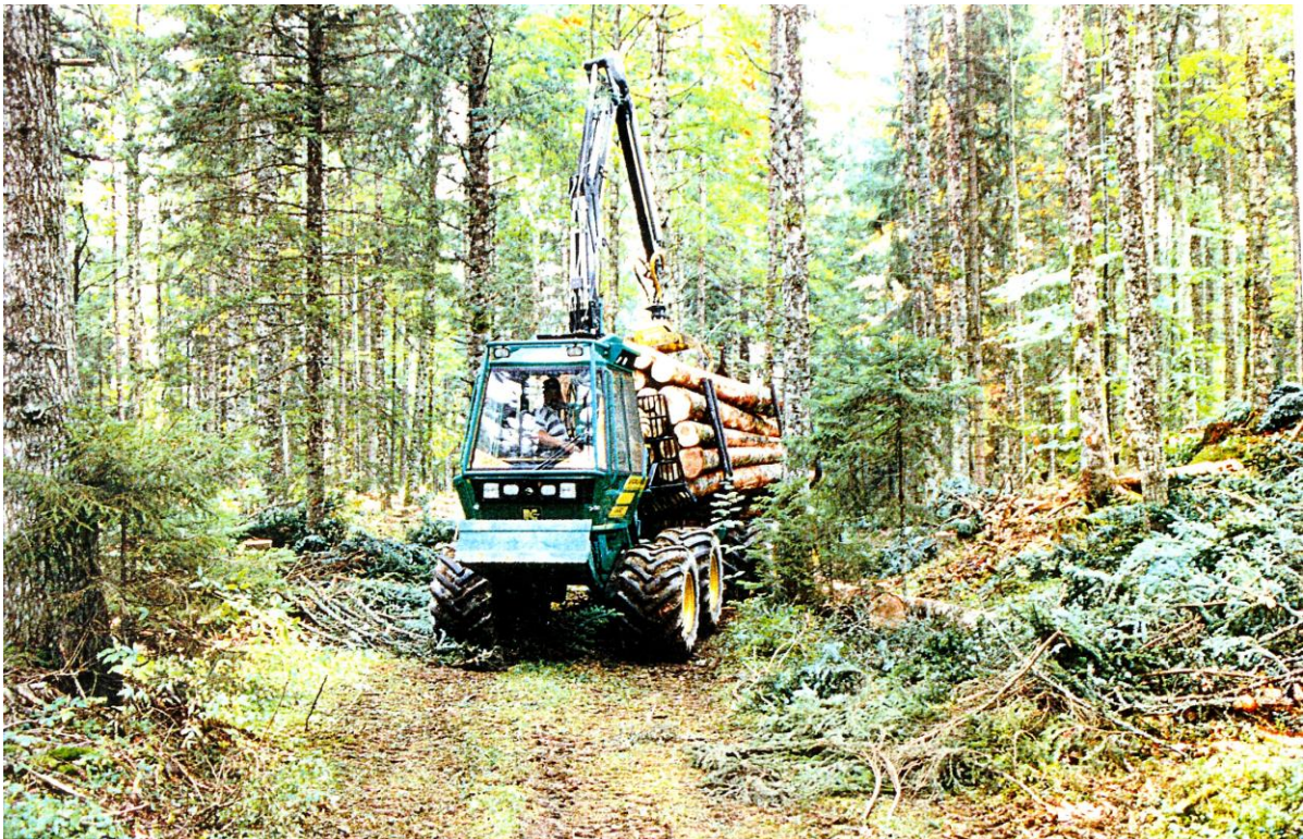
La panier, le débardage le plus moderne et le plus efficace avec des troncs de 4 m.
