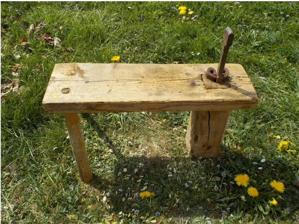
Le banc à enchapler. 40 à 50 cm de haut, 60 cm de long et la largeur juste pour que l'on soit à l'aise.
