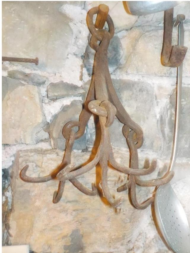
La rampanella soit l'engin que l'on descend dans le puits quand un bidon s'y est perdu. Avec trois branches possédant chacune trois crochets, la pêche miraculeuse est possible dans les meilleures conditions.
