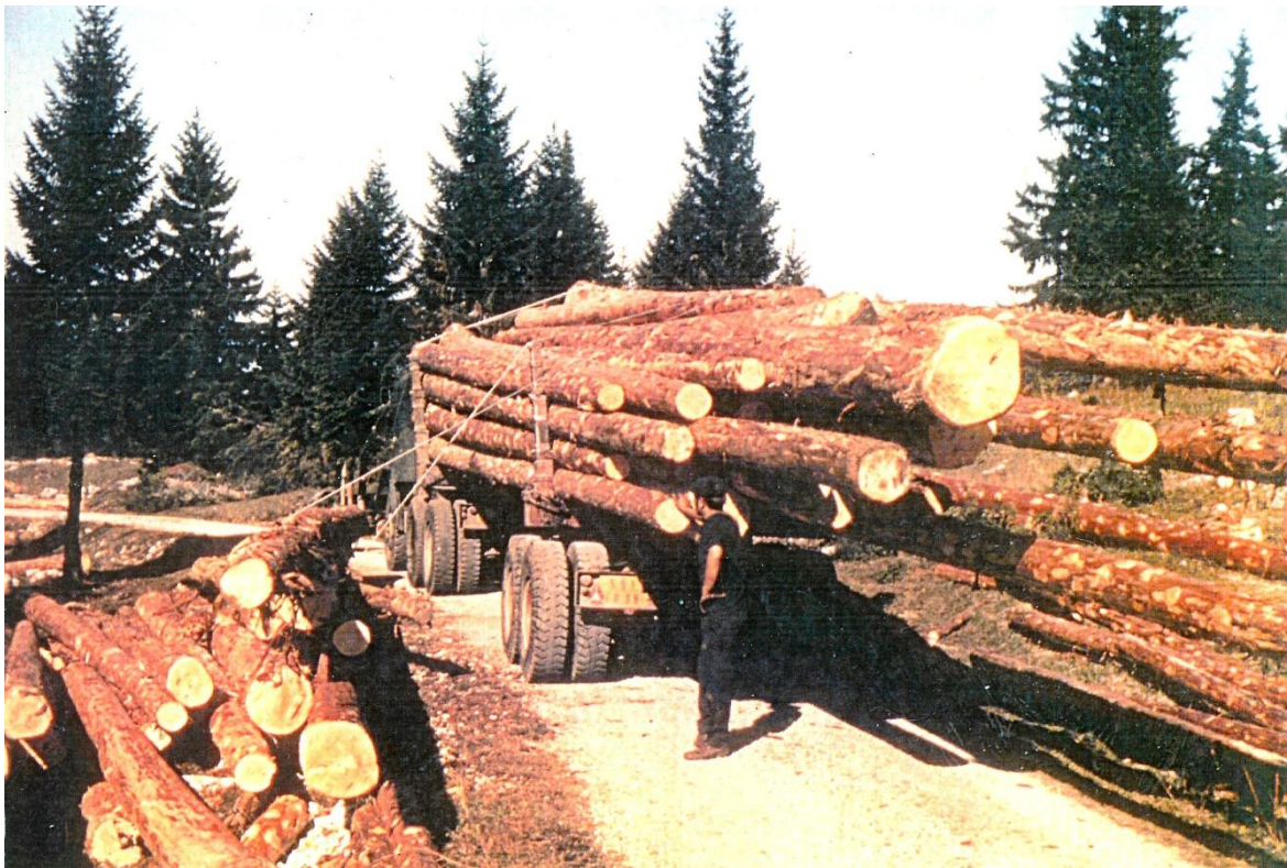
La manière de composer un chargement. Au câble et au treuil.
