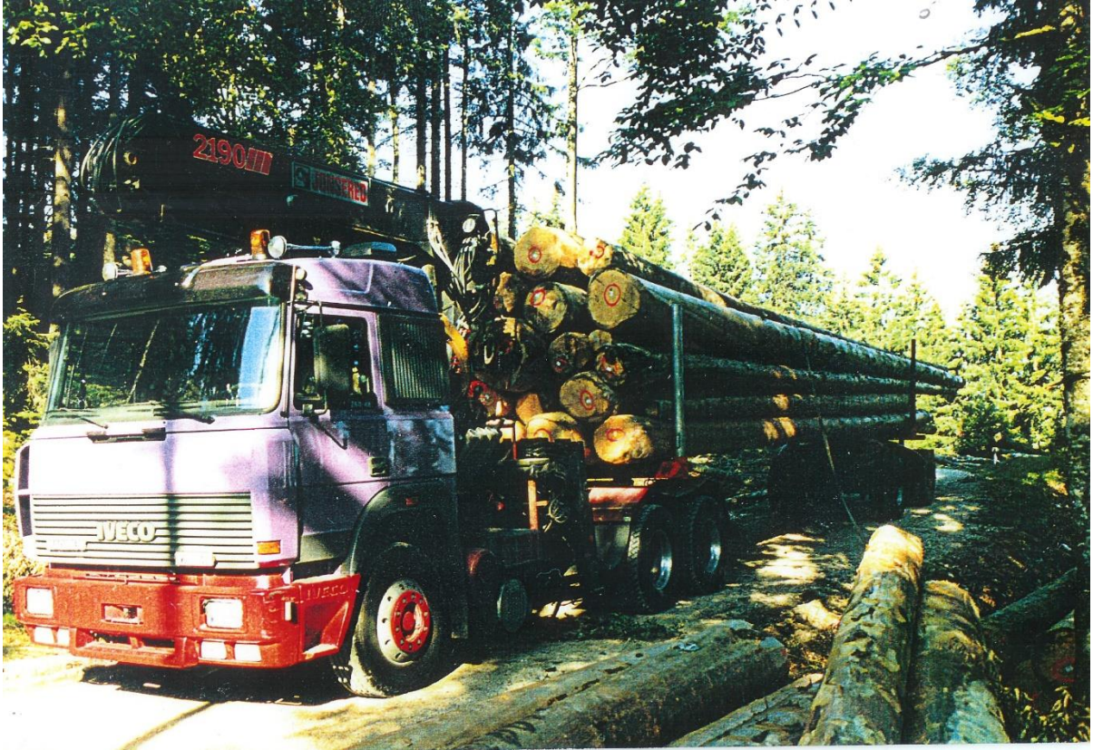
La grue a remplacé le treuil.
