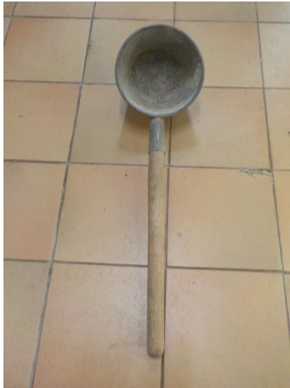
La poche pour transférer l'eau de la chaudière au bac.
