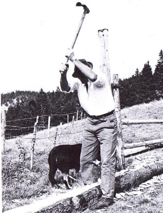
Le maniement de la « gouge à cheneau » pour creuser une auge à porcs (Alpes de La Vaux, Mauborget)
