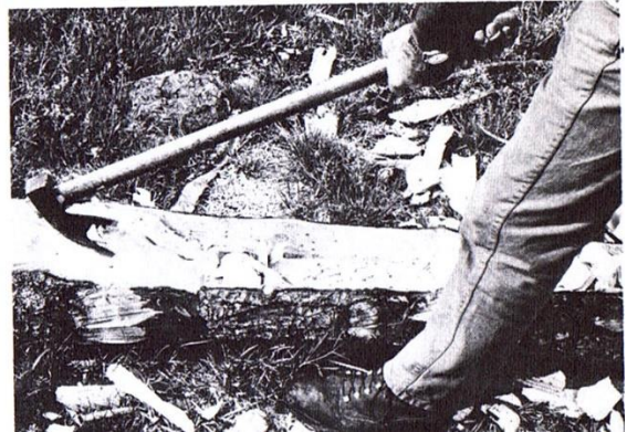
Le maniement de la « gouge à cheneau » pour creuser une auge à porcs (Alpes de La Vaux, Mauborget)
