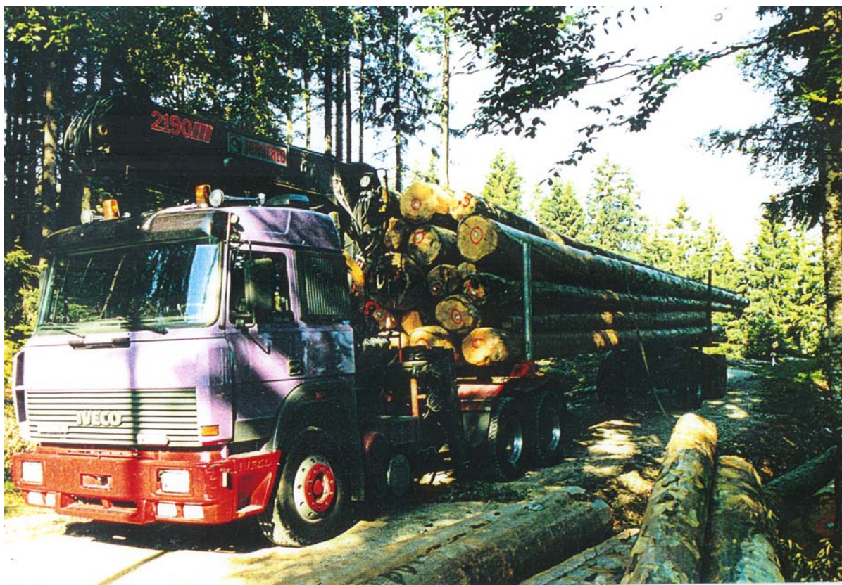
La grue a remplacé le treuil.
