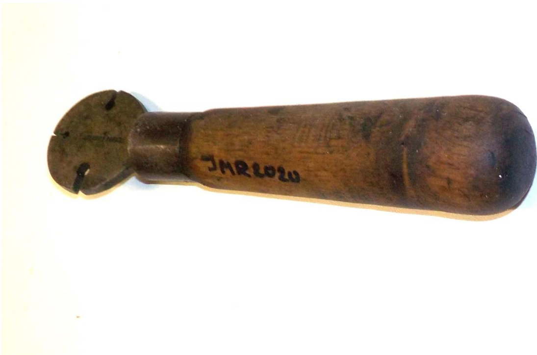
Un tourne à gauche pour redonner du champ aux lames des scies. Objet de petites dimensions.
