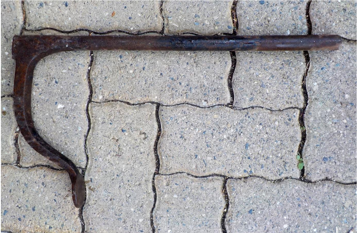
Le valet, utilisation sur le banc de menuisier pour bloquer certaines pièces à travailler.
