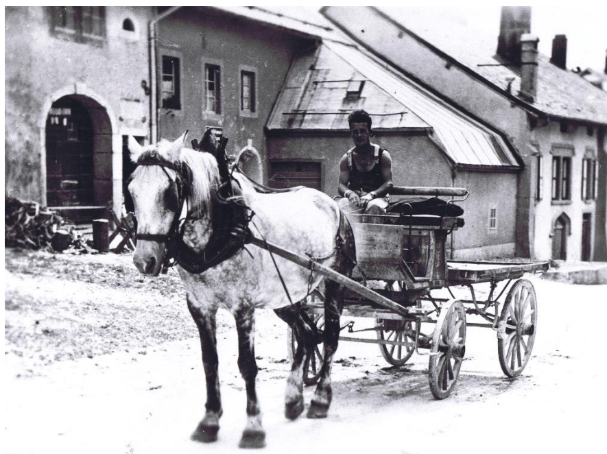
Char au Lieu. Le siège du conducteur à l'avant et le pont à l'arrière pour les marchandises.
