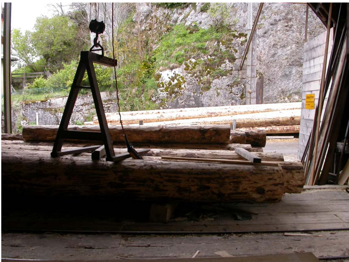
L'élévateur, avec moufle électrique.
