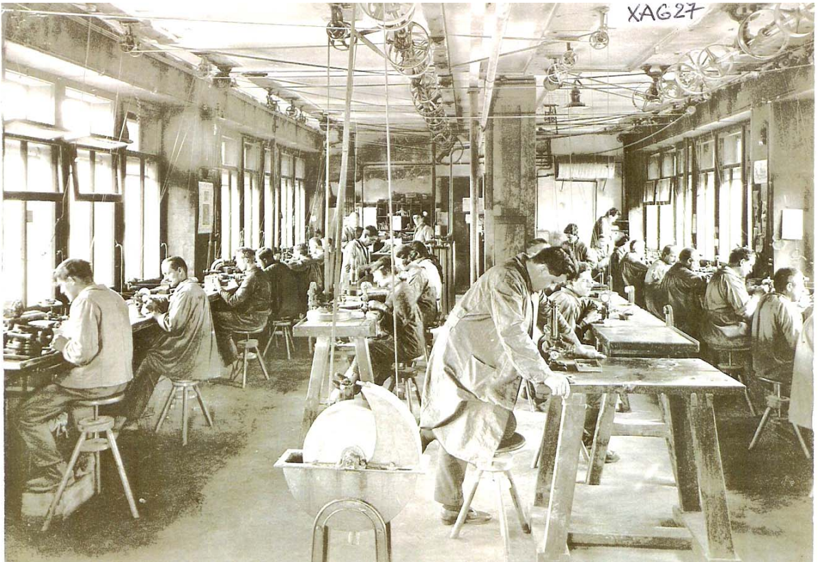
Système de poulies et de transmission dans un atelier du Lieu, vieux Moutier sans doute.
