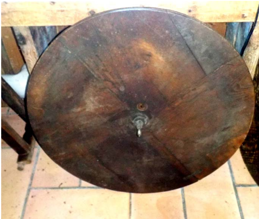
Roue d'entraînement en plusieurs parties. Elles s'emboîtent les unes dans les autres.
