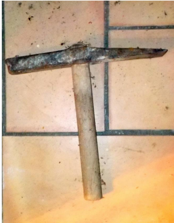
Le marteau du maçon est lui aussi primordial. Il comprend souvent une partie arrache-clous.
