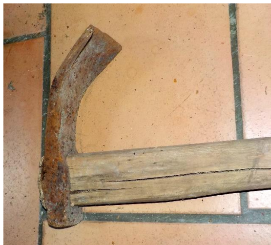
Herminette, longueur du manche 1 m. environ et ci-dessous détail du fer.
