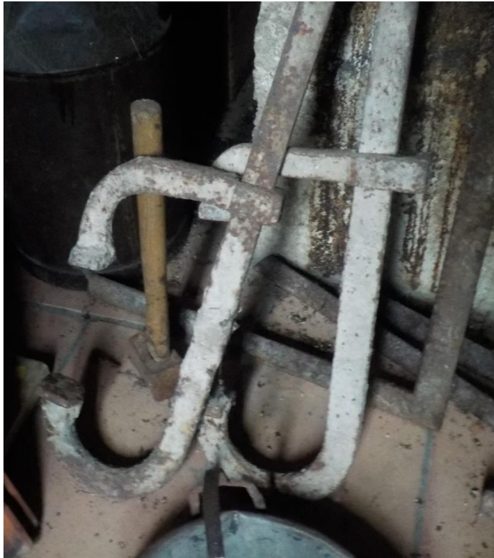
Le serre-joint du maçon pour maintenir les coffrages.
