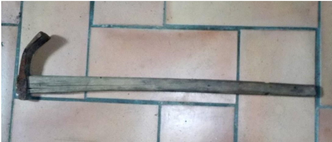
Herminette, longueur du manche 1 m. environ et ci-dessous détail du fer.
