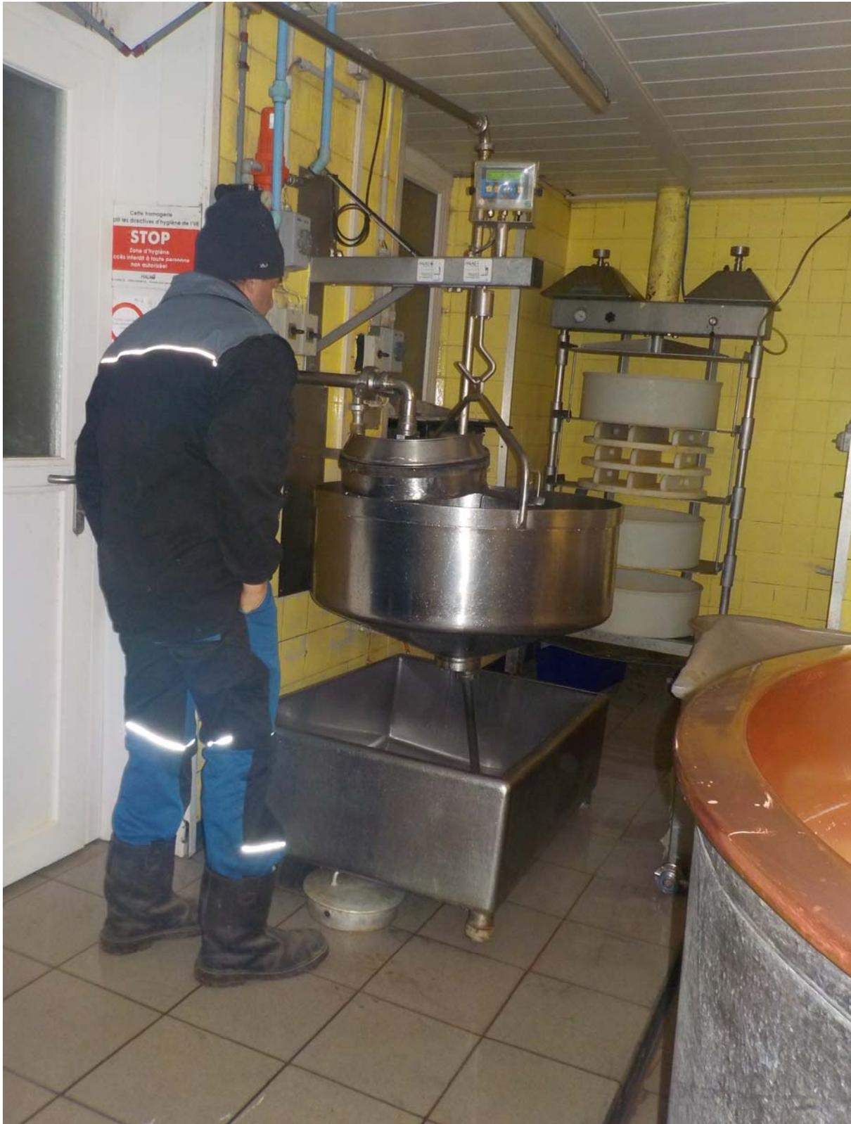
Par des conduites en acier-inox, le lait arrive dans le pèse-lait. De là il sera ensuite pompé directement dans les chaudières où se fera la fabrication.
