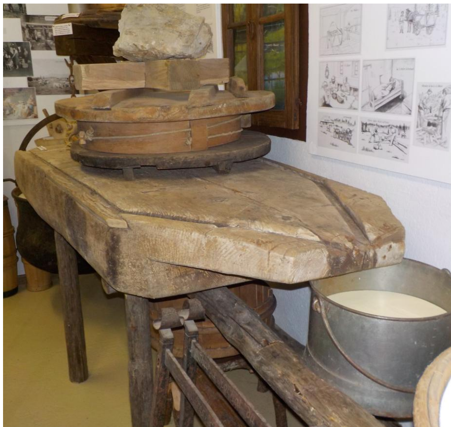
Enrochoir antique, avec l'écoulement sur les bords du petit lait. Dessus deux foncets, un cercle à fromage (gruyère) le croisillon et la pierre en guise de poids ou de presse.
