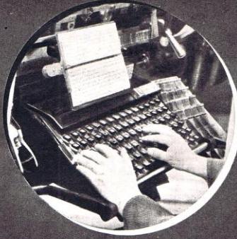
Le compositeur à la machine travaille sur un clavier analogue à celui d'une machine à écrire. Il n'opère pas par lettres isolées comme le compositeur à la main, mais par lignes entières.
