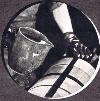
Le cylindre passe à la gravure. Après avoir enduit de bitume les espaces vides, le graveur revêt des gants de caoutchouc et arrose soigneusement le cylindre de chlorure de fer, acide qui mord et creuse les parties vides du cuivre.
