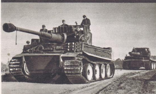
Le « Tigre », le nouveau char de combat allemand, long de 7 m. et large de 3 m., muni d'une tourelle tournante et d'un canon long. C'est une arme puissante, mais qui ne paraît pas avoir pu intervenir en nombre suffisant en Tunisie.
