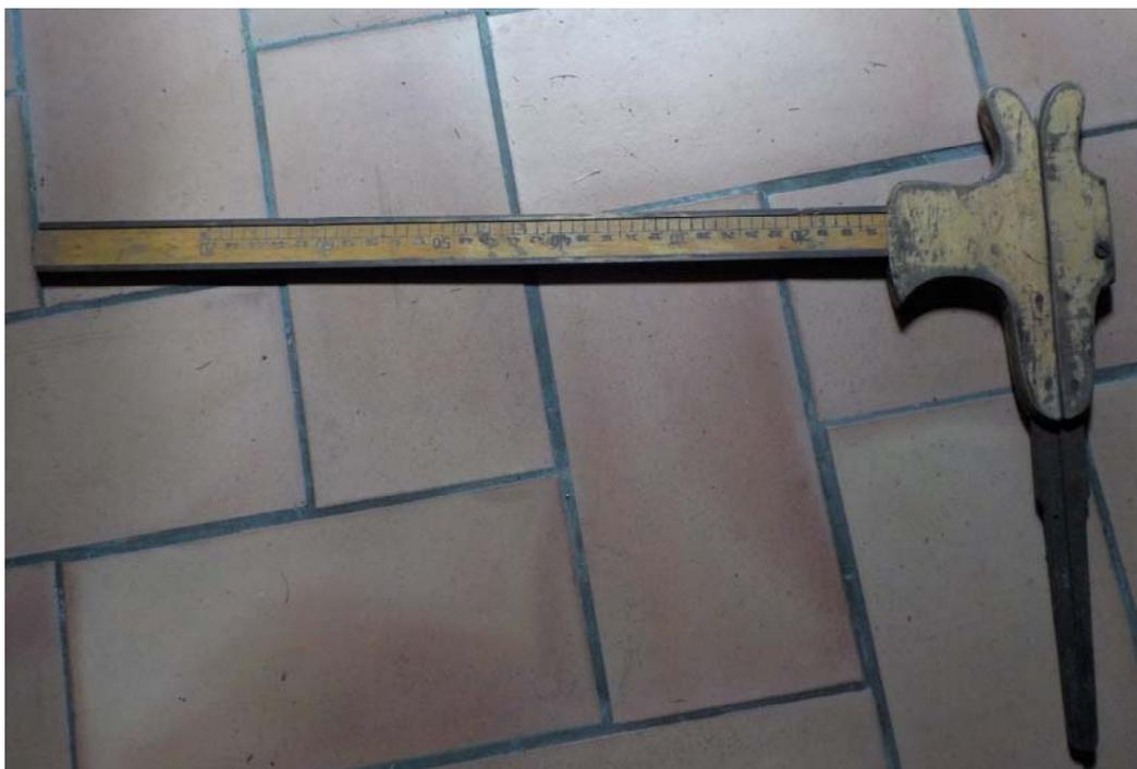
La mesure ou pied à coulisse pour déterminer le diamètre des arbres, en général à hauteur de poitrine.
