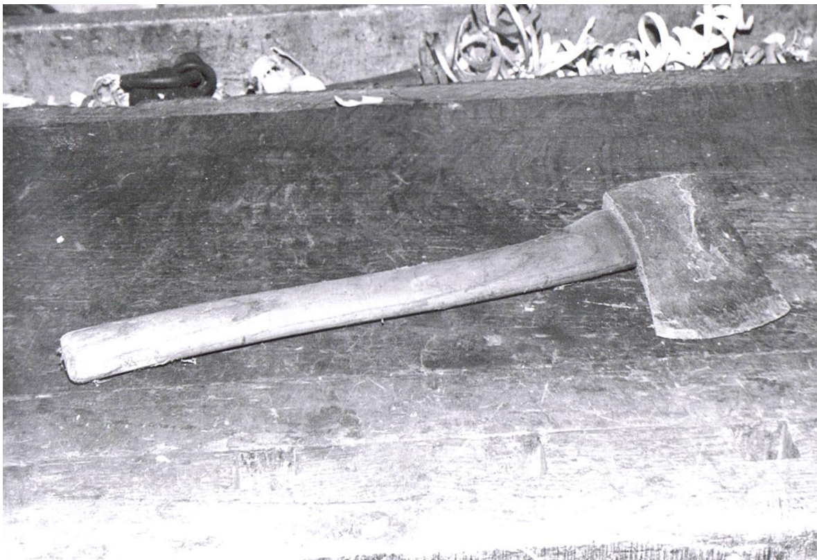
La grive, servait à découper des fonds ou des couvercles de boîtes à vacherin.
