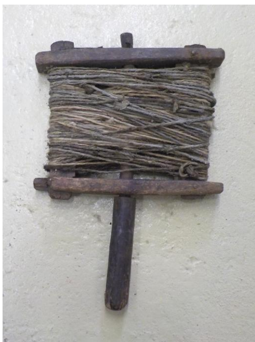
Le dévidoir. La ficelle, imprégnée de craie rouge pillée, est tendue d'un bord du toit à un autre, et, pincée, elle dépose sa couleur sur les tavillons sous-jacents.
