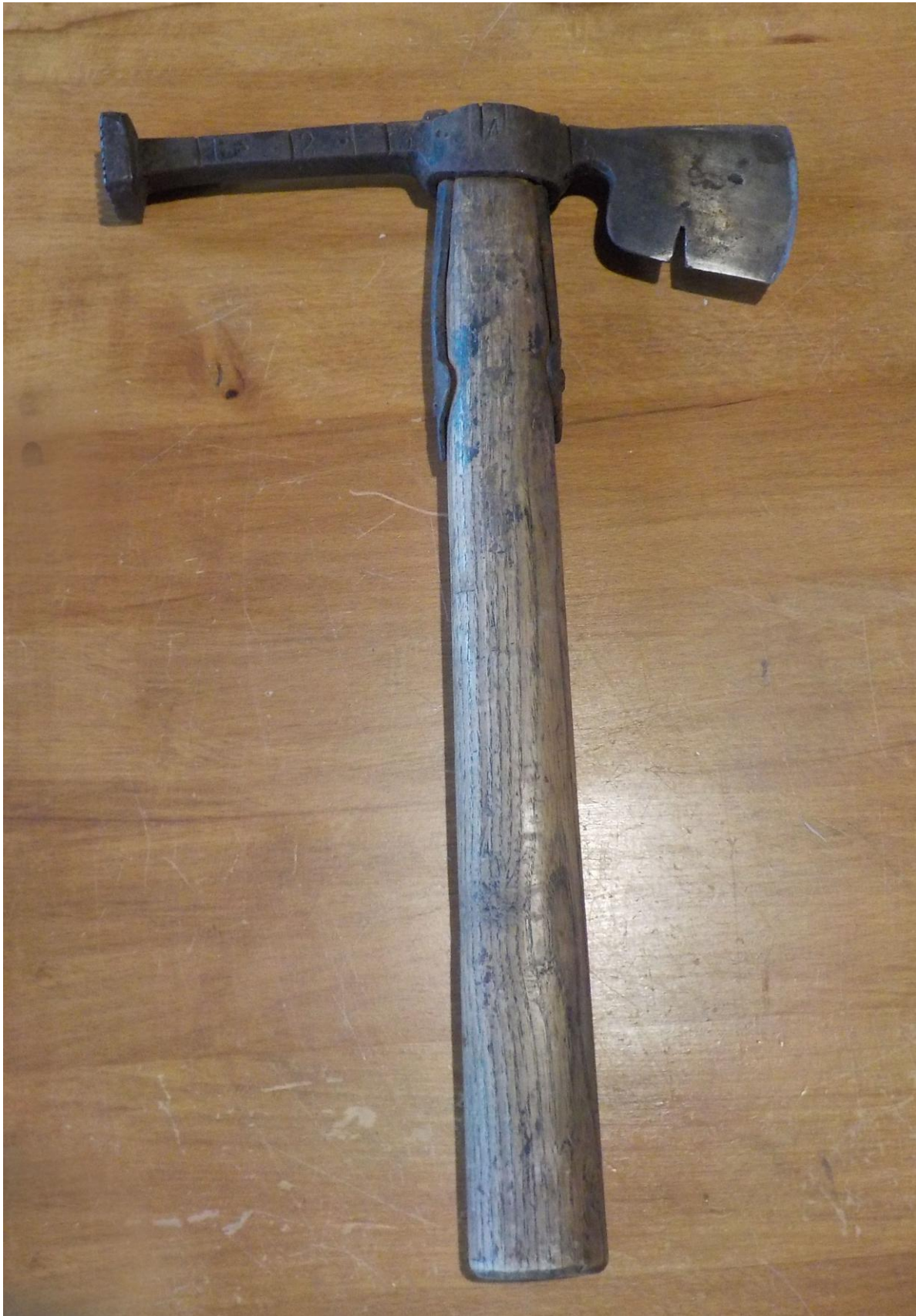
Le marteau-hache à « talon haut », avec sa table de frappe longuement pédouculée.
