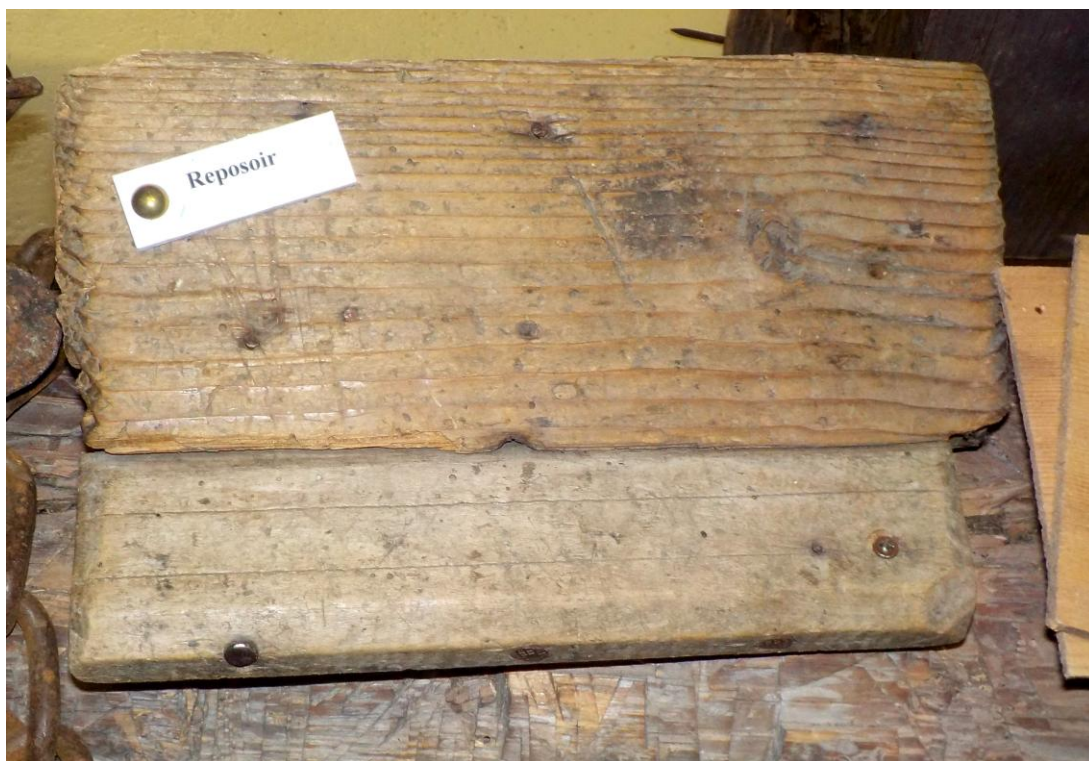
Le reposoir, avec des pointes sur la partie inférieure pour mieux adhérer aux premières rangées de tavillons du toit.
