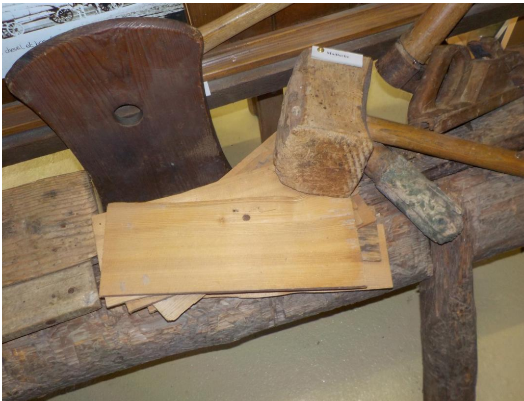
Le banc du tavillonneur, un simple tronc écorcé avec une encoche pour placer le tavillon et quatre pieds. A gauche le reposoir, un pair de tavillons, la mailloche.
