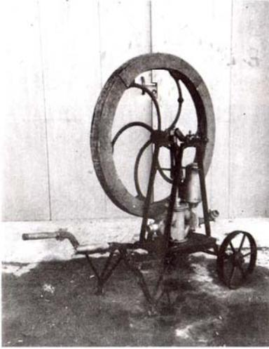
*Pompe de cave actionnée à la main au départ (fabrication en 1925 environ). Un moteur électrique a ensuite été monté.*
