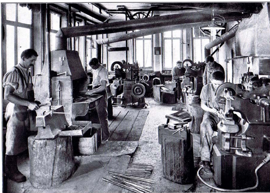
Fig. 7. — Le forgeage des limes, à la main et au marteau-pilon.
