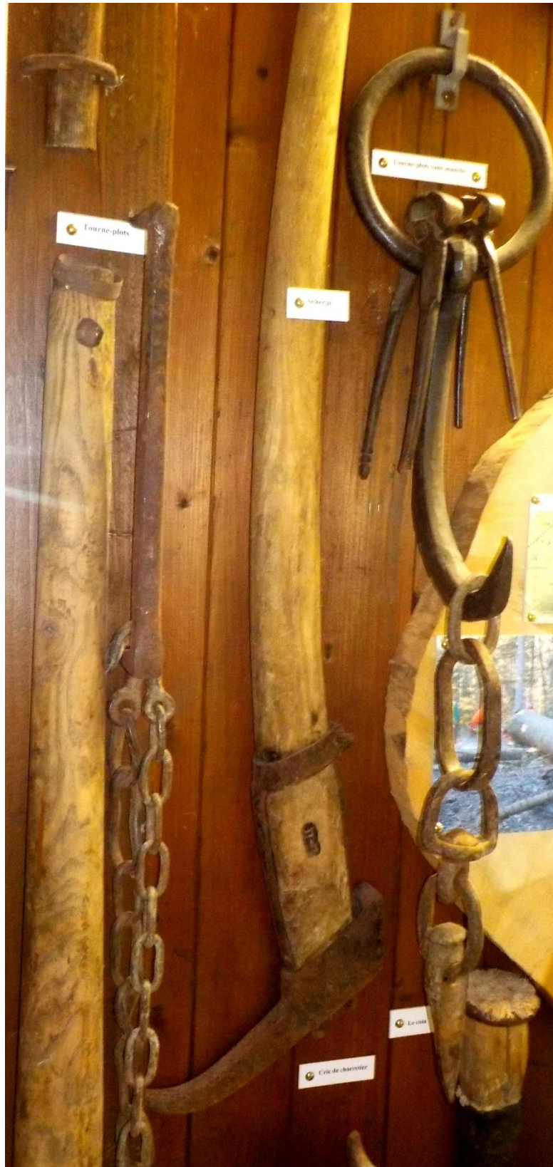
Scherpi, coin, coumangle, fer de tourne-plot. Le manche de celui-ci sera constitué d'une grosse branche que l'on taille sur place. A gauche le manche d'un tourne-plot traditionnel.
