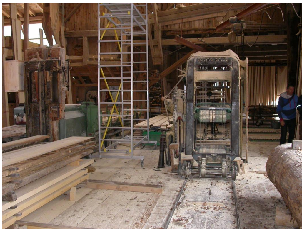
La multiple, cœur de la scierie. « Une pièce importante viendrait à lâcher, nous dit Jean-Victor Bonny, mon entreprise de sciage est foutue ! »
